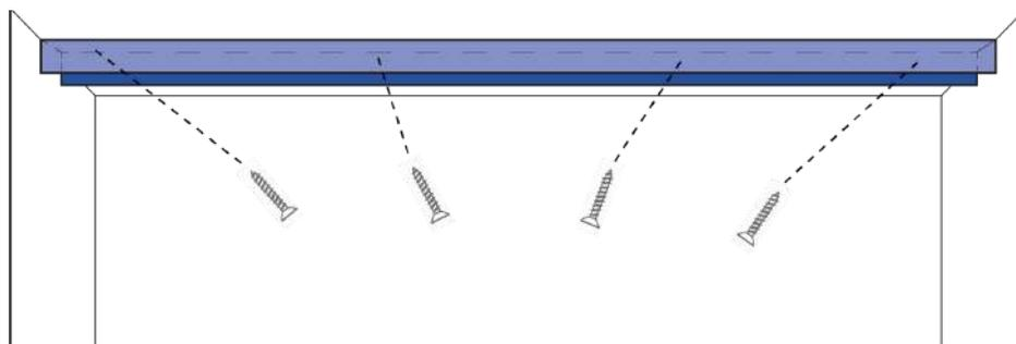
4. Aligner 4 plaques de fixations (**D**) à la verticale d'un côté et vérifier à l'aide d'un niveau. Percer, puis fixer les plaques au mur avec les vis et chevilles.
