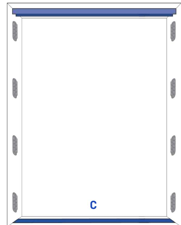
7. Enfin, aligner et clipser les 2 packs de toile **(A)** directement sur les plaques de fixations **(D)** de chaque côté (que celle-ci soit fixée sur le mur ou dans les profils de pose facile **(F)**). Commencer par incliner le coffre vers le haut et l'enclencher dans le rail supérieur. Puis enclencher progressivement le coffre dans le rail inférieur et les plaques. **ATTENTION ! La chaîne doit être placée en bas.**
